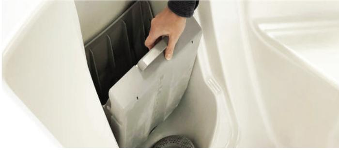
**Étape 4 :** Retirez et remplacez le filtre. Pour retirer le filtre Simplicity, comprimez les plis et poussez légèrement vers l'avant. Soulevez le bord du filtre au-delà de la languette de capture. Cela vous permettra de soulever le filtre usagé du porte-filtre. Jetez le filtre usagé.
