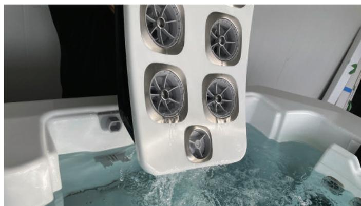
**Étape 5 :** Abaissez soigneusement le collecteur du nouveau JetPak afin d'aligner l'ensemble de valves inférieurs et le joint dans le raccord de cloison. Appliquez une pression vers le bas lorsque vous déplacez le collecteur du JetPak jusqu'à ce que le collecteur soit fixé dans l'ensemble de fixation murale.manifold until the manifold is secured in the wall clip assembly.
