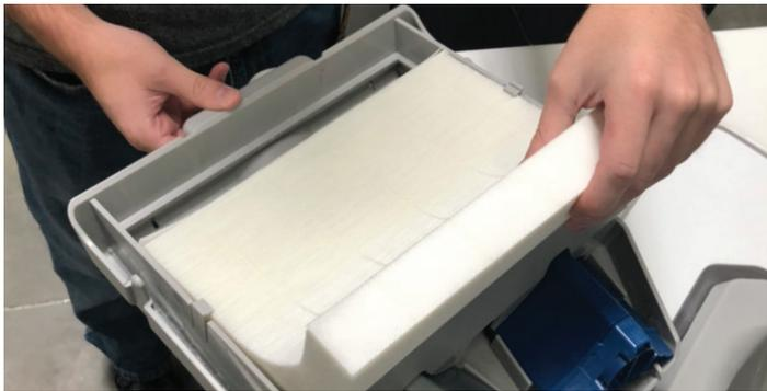
**Étape 5 :** Réinstallez le porte-filtre Simplicity dans la capsule avec la poignée vers le haut. Alignez le bas de l'unité dans le boîtier avec la poignée vers le haut et enclenchez l'unité de filtration en place dans le boîtier avec un mouvement de va-et-vient.
