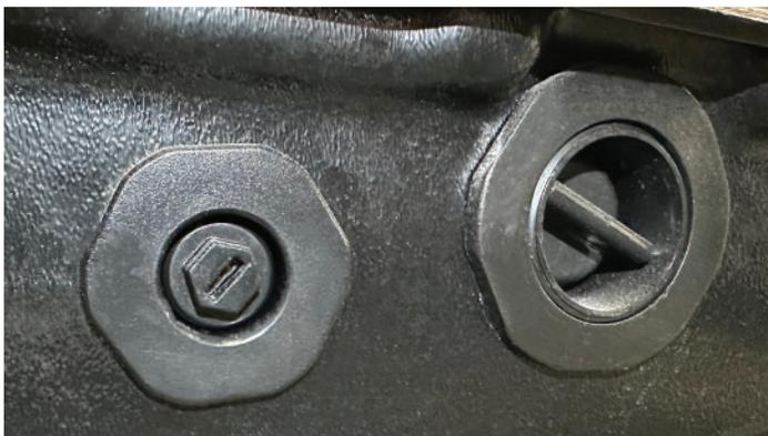
*(Vis de purge d'air et vis (à gauche de la sortie de vidange))*
