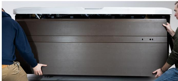
**Étape 3 :** Une fois qu'elle est libérée des anneaux de retenue inférieurs, soulevez la porte d'environ un centimètre pour la dégager de la rainure du taquet français. Une fois que le panneau de porte a franchi la rainure de l'anneau de retenue et le taquet français, abaissez-la lentement jusqu'au sol.
