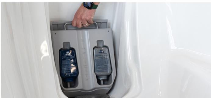
**Étape 4 :** Retirez et remplacez le filtre. Ouvrez le porte-filtre Simplicity pour exposer le filtre. Saisissez d'une main la boucle située en haut du filtre et soulevez-le, en vous servant de l'autre main pour vous aider à le retirer. Jetez le filtre utilisé.
