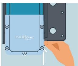
Tirez la cartouche CCW25 vers le bas jusqu'à ce que les fentes de la cartouche soient alignées avec les crêtes de guidage du contrôleur (environ 2,5 cm/1 pouce).
