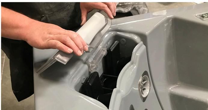
**Étape 2 :** Placez un tuyau d'arrosage dans l'ouverture derrière le JetPak.
