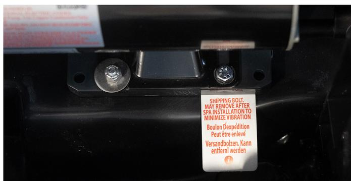
**Remarque :** Il se peut que votre spa soit livré avec un boulon pour fixer les pompes à jet pendant le transport. Ce boulon d'expédition est étiqueté et se trouve près du pied de la ou des pompes à l'intérieur de la zone d'équipement. Ce boulon est
