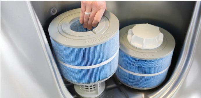
**Étape 4 :** Nettoyez la ou les cartouches à l'aide d'un tuyau d'arrosage avec une buse ou un autre dispositif à haute pression. Commencez par travailler de l'intérieur, du haut vers le bas sur chaque pli puis de l'extérieur, du haut vers le bas sur chaque pli.
